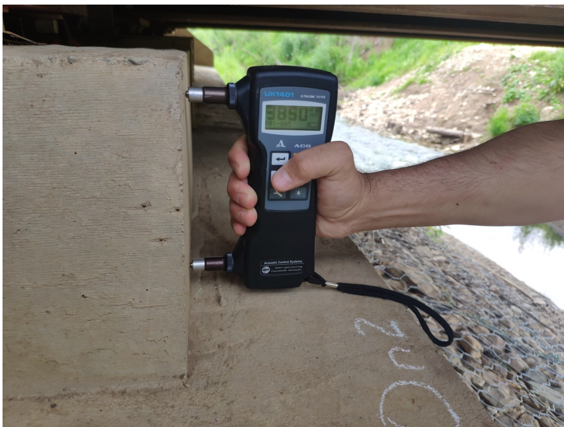
Рисунок 29 – Измерение скорости методом УЗК на подферменнике
