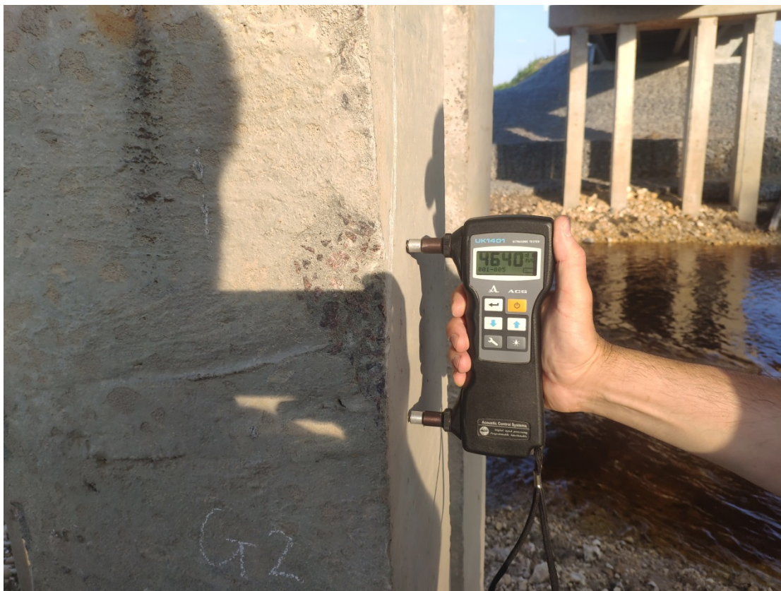
Рисунок 20 – Измерение скорости методом УЗК на стойке опоры
