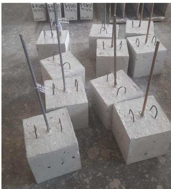
Рисунок 1.3 Образцы арматуры А500СП и А500С в бетонных кубах на вырыв, подготовленные для испытаний
