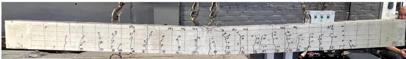
Рисунок 5.2 Балка №1 после испытания
