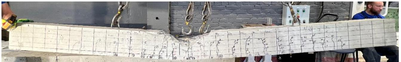
Рисунок 5.10 Балка №3 после испытания
