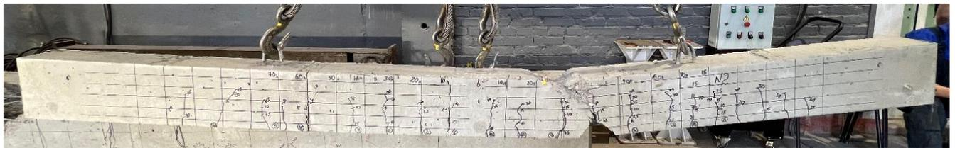
Рисунок 5.6 Балка №2 после испытания
