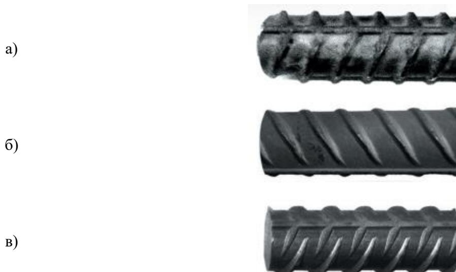
Рисунок 1.1 Профиль арматуры класса А500С и А500СП: а) кольцевой, б) серповидный двухсторонний, в) серповидный четырехсторонний.
