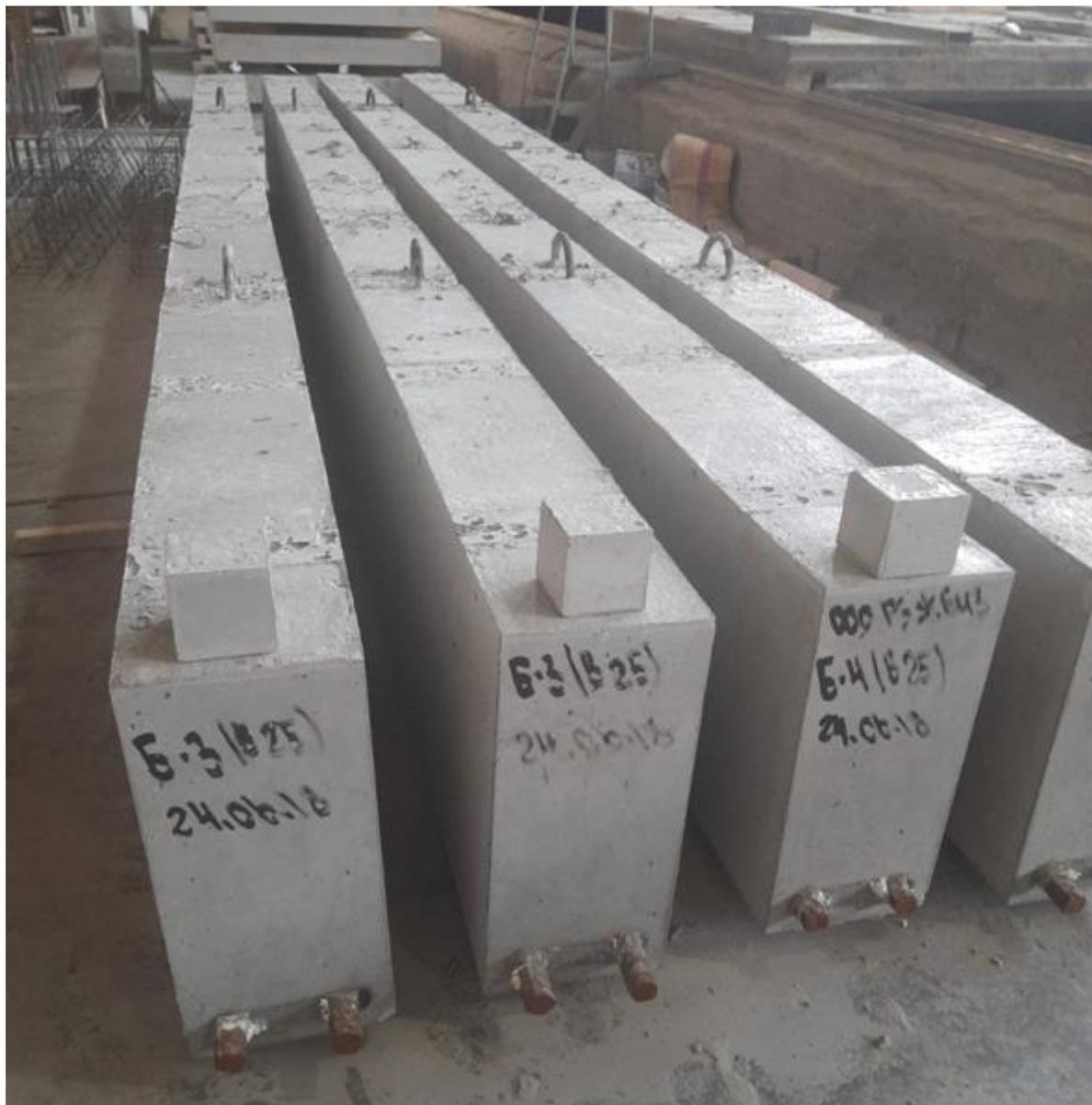
Рисунок 1.4 Железобетонные балки Б1, Б4 армированные арматурой А500СП и А500С
