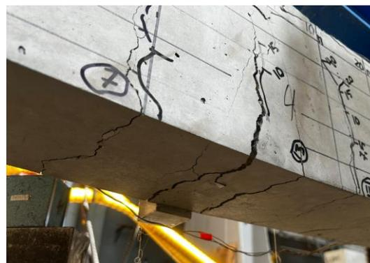
Рисунок 5.4 Балка №1 место разрушения
