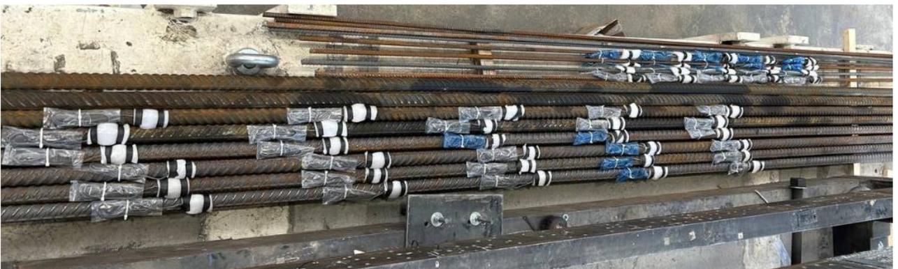
Рисунок 2.3 Расклейка тензодатчиков: а) схема расклейки на арматуру; б) расположение датчика на арматуре; в) защита датчиков при транспортировке.
