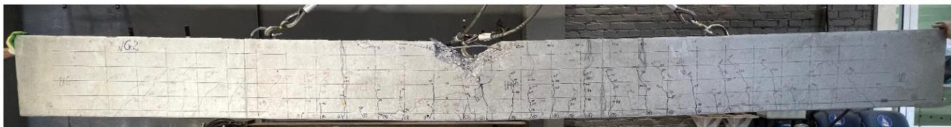
Рисунок 5.30 Балка №6.2 после испытания
