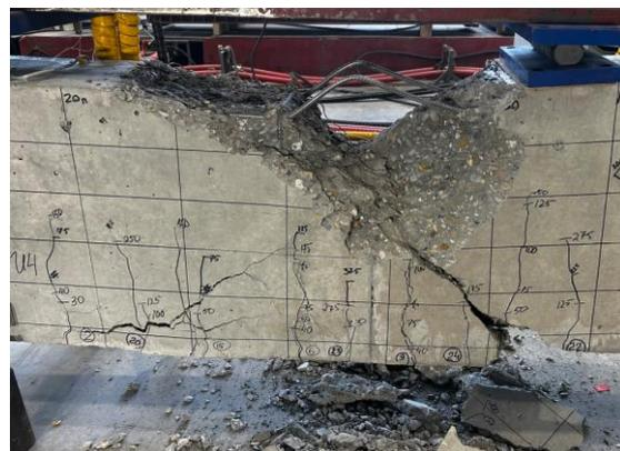
Рисунок 5.24 Балка №5 место разрушения
