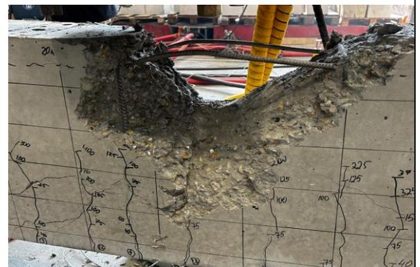
Рисунок 5.20 Балка №4 место разрушения
