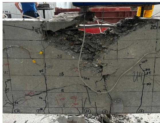
Рисунок 5.32 Балка №5 место разрушения
