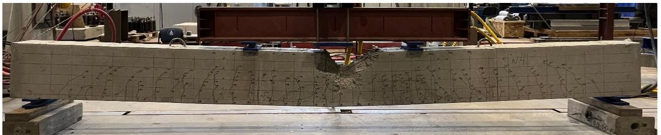
Рисунок 5.18 Балка №4 после испытания
