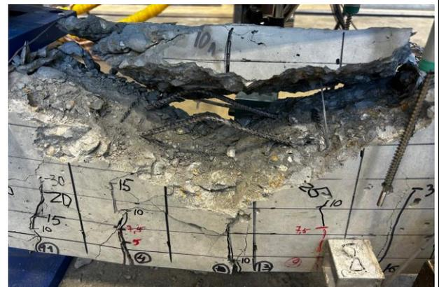
Рисунок 5.12 Балка №3 место разрушения
