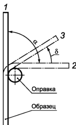
Рисунок Б.2 — Схема устройства для разгиба
