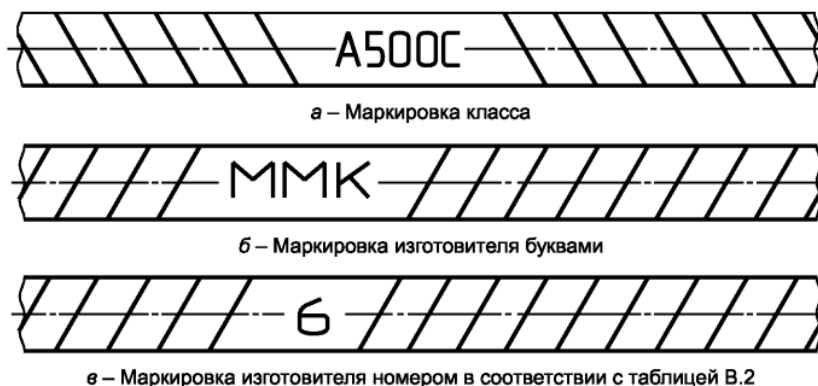
Рисунок В.1 — Маркировка проката надписью
