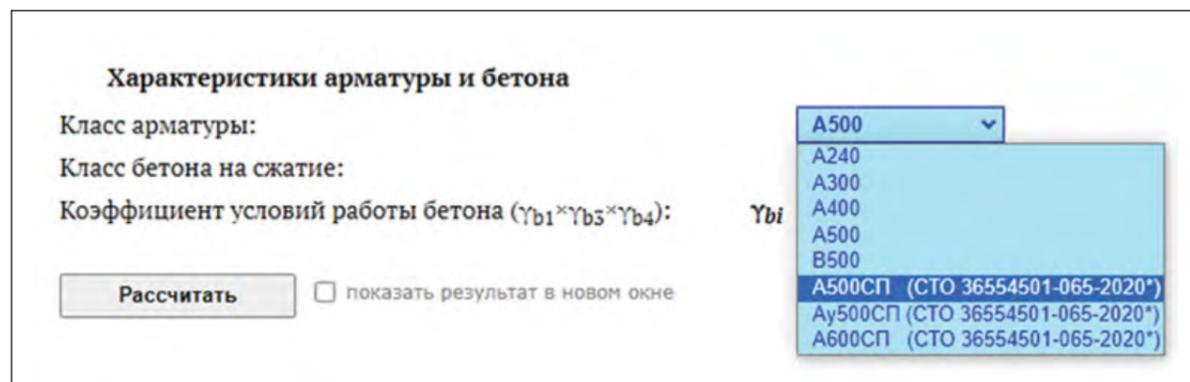
Кроме того, даже в случае наличия более старых версий программных комплексов ключевая характеристика АРМАКС (A500СП) для изгибаемых и внецентренно сжатых элементов – меньшая ширина раскрытия трещин, соответствующая  $\phi_2=0,4$ , может быть учтена следующим образом:
