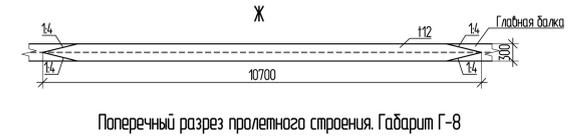
Поперечный разрез пролетного строения. Габарит Г-8
