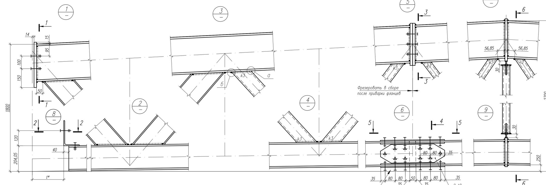
Фрикционное соединение на ВПБ М24-10.9
