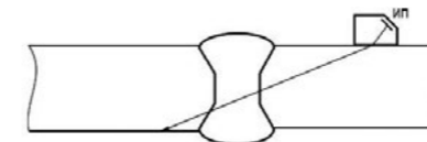
А. Схема прозвучивания стыкового сварного соединения прямым лучом
