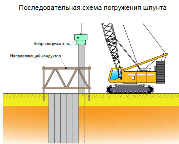
Рисунок 19 – Последовательная схема погружения шпунта
